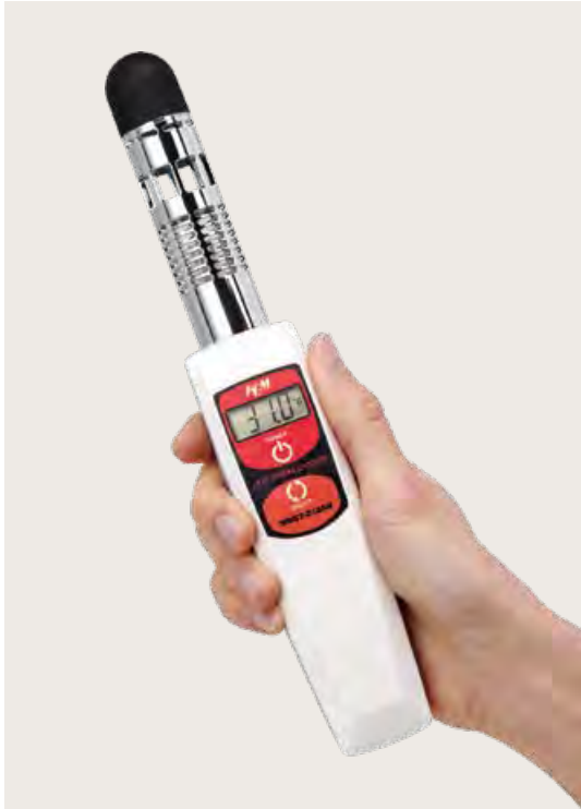
写真1.WBGT 値の測定器 持ち運べるハンディタイプや、卓上型など、さまざまな商品があり、JIS 規格に適合したものは正確な測定ができます。目安を知るための簡易的なものは数千円から市販されています。 写真提供：京都電子工業株式会社
