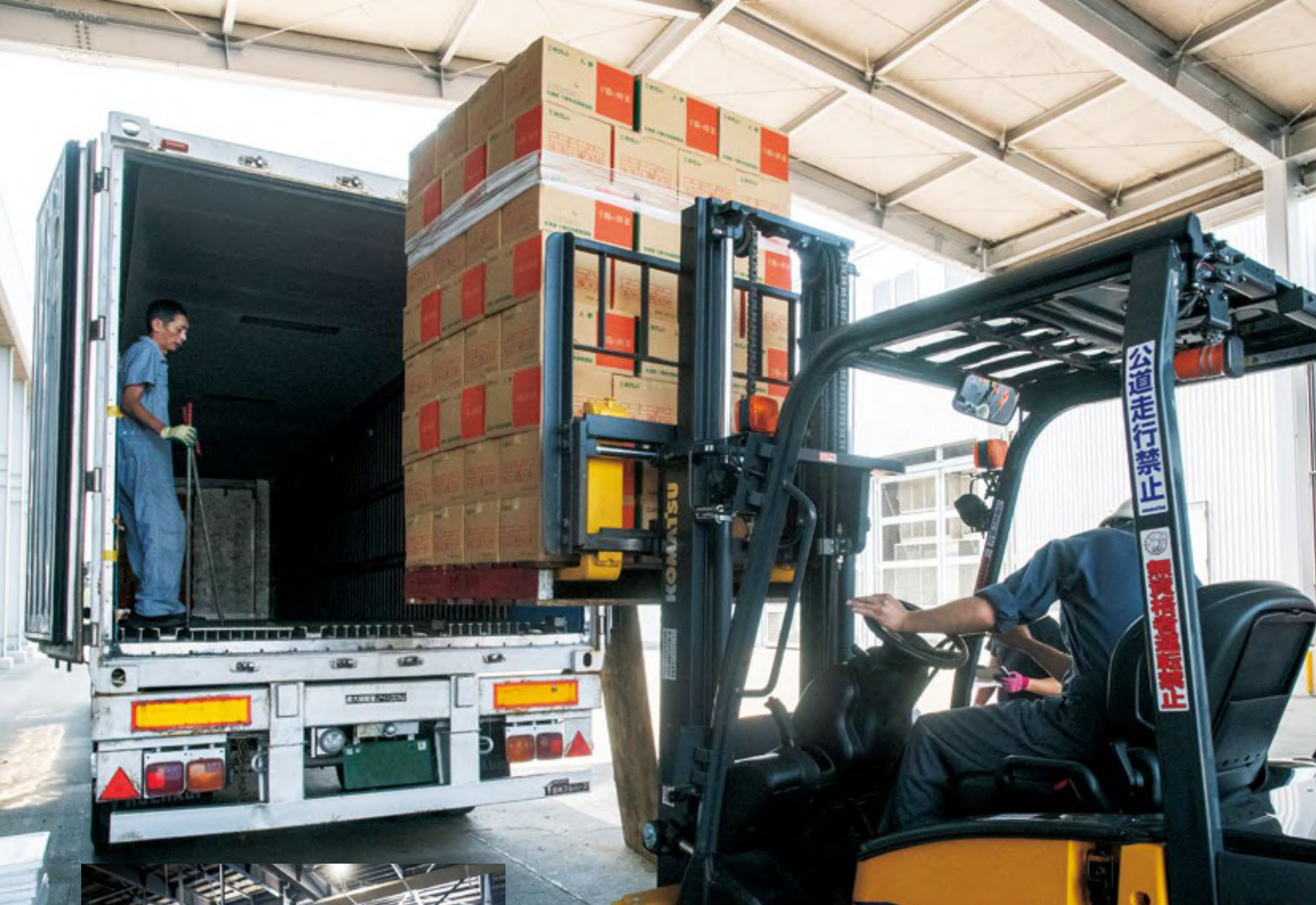
写真1. 段ボールを載せたパレットごとトラックに積み込み、床面のレールとの間に移動装置を差し込み奥へとスライドさせ、次々に積み込んでいく。
