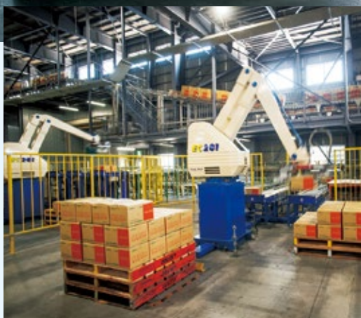
写真2. レンタルパレットに自動で段ボールを載せる。
