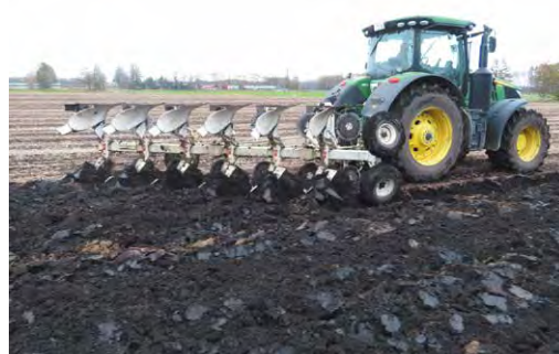
図3. プラウによる反転耕起 (農業機械の構造と利用(農文協)を一部改変)
