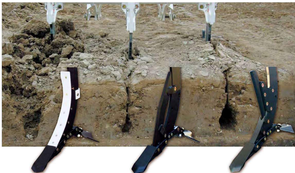
サブソイラの施工は毎年少しずつ角度を変え、より効果的です。
