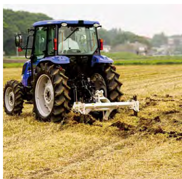
サブソイラの施工は毎年少しずつ角度を変え、より効果的です。
