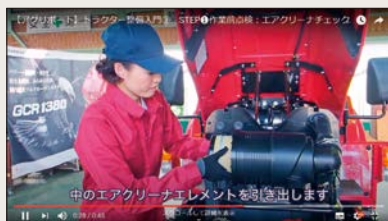
作業前点検：エアクリーナチェック
