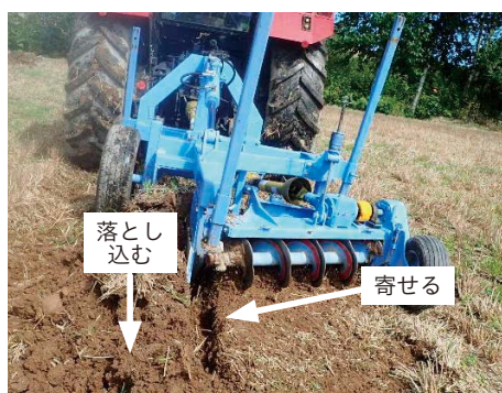
写真1. カットソイラー施工の様子（左・8月中旬）と施工部の土壌断面（右・白線で囲った部分が作物残渣の埋設部）
