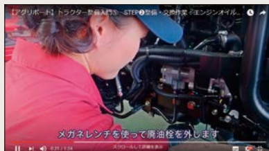
整備・交換作業：エンジンオイル交換
