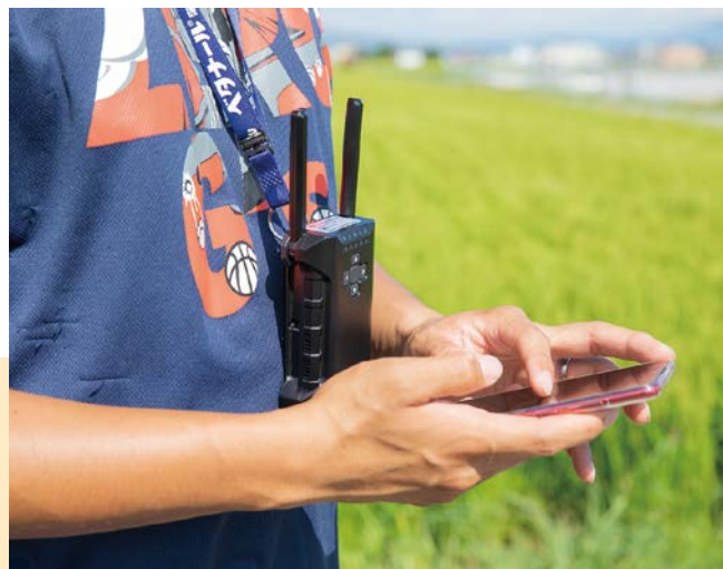
写真 2. 胸に下げているのがドローンに無線で指示を飛ばす 操縦アンテナ ACB-1。フライトの指示はスマートフォンの ボタン操作だけ。画面には散布作業時間や面積に応じた散 布量が表示されます。
