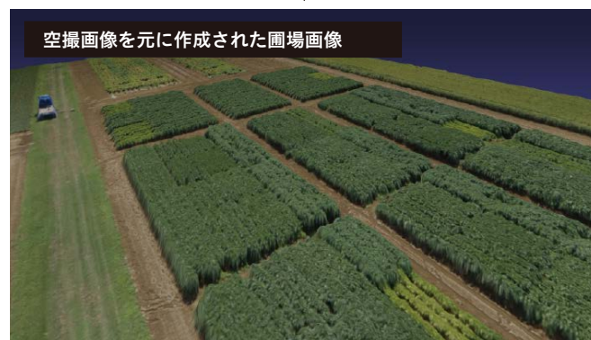
図 2. ドローン空撮画像からの三次元情報の復元
