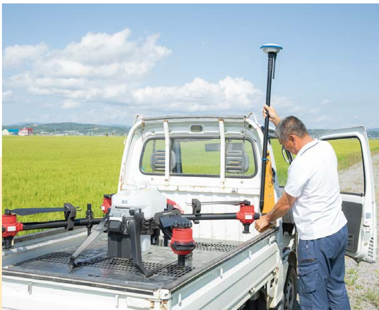
写真 3. XAG 社の P30 は中国製。軽トラックにそのまま積み込めるサイズです。 事前に RTK アンテナ（移動局）（熊谷さん手元）を使い圃場を測量します。
