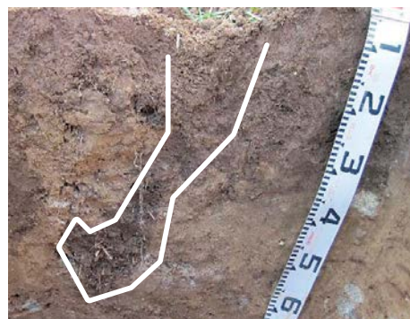
写真1. カットソイラー施工の様子（左・8月中旬）と施工部の土壌断面（右・白線で囲った部分が作物残渣の埋設部）
