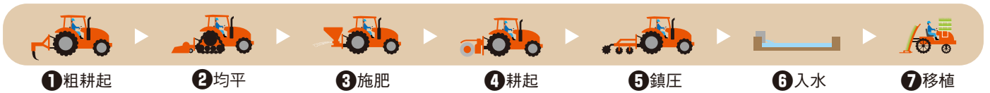
図1. 無代かき栽培 作業フロー (イメージ)
