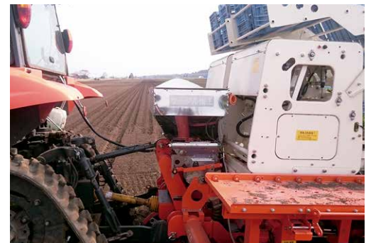
写真3. 移植機のサブタンク（中央部の銀色のタンク）で定植時に作条に施肥
