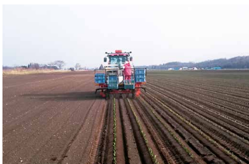
写真2. 新作業体系での定植作業の様子 事前に畝切りをしなくても、自動操舵のおかげで真っすぐ植え付けできている。
