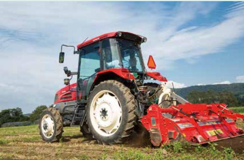
自動操舵によるロータリー作業の様子。直進のハンドリングは自動、運転手はガイダンスモニターのチェックや安全性の確認を主にを行います。旋回は手動ですが、将来的には旋回も自動化されるとわれています。
