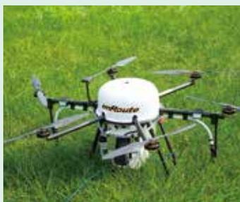
今回デモ飛行に使用した機材。重さは約10kgと、一人でも持ち運びが可能。5Lの液剤が散布できます。
