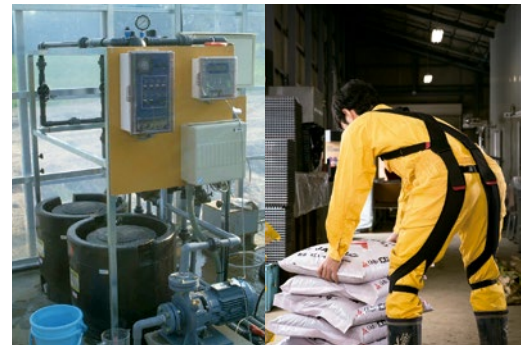
写真2. かん水に要する労力を軽減する自動かん水装置(左)と身体の疲労と負担を軽減できるアシストスーツ(右)。
