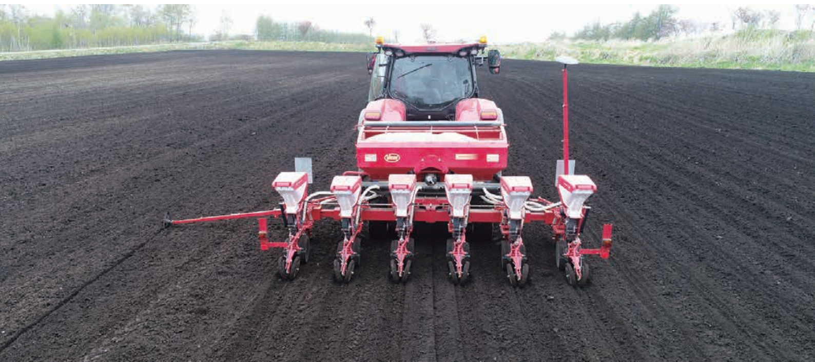
写真1. 大型真空播種機「Multicorn DP II」株式会社ビコンジャパン 播種ユニットの油圧調整により畦間を45～80cmの間で1cm単位で変えられる。また、ISOBUSの活用により播種位置の高精度な制御が可能。現在は10台程度が十勝で普及。
