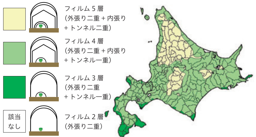
図1.-5℃を確保するために必要な道内各地におけるパイプハウス保温 装備の目安
