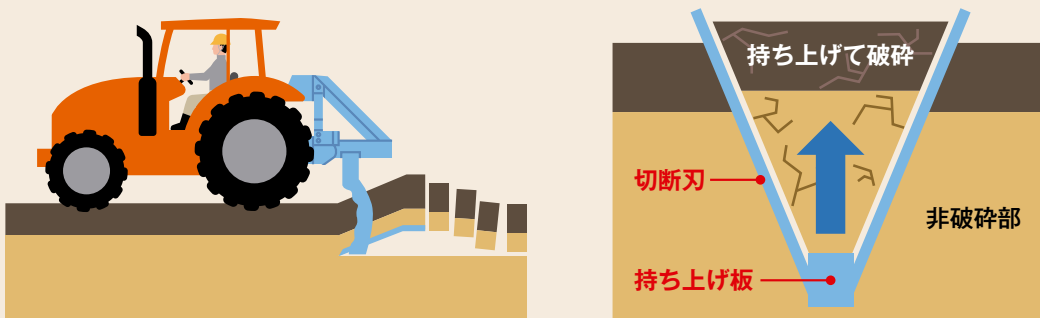
図1. カットブレイカー施工原理（農研機構「カットシリーズ」パンフレットより作成）
