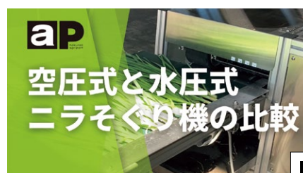
写真 2. 空圧式ニラそぐり機 一度に10束程度をつかみ、圧縮空気により下葉、土を取り除く。
