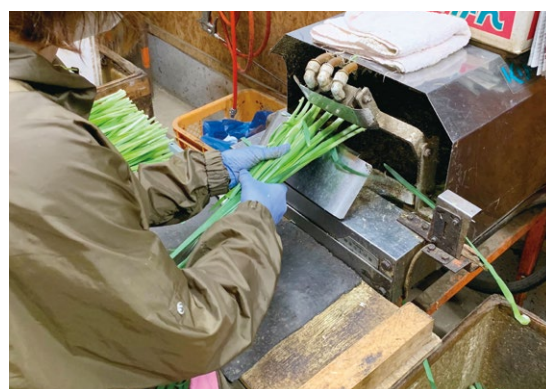
写真 2. 空圧式ニラそぐり機 一度に10束程度をつかみ、圧縮空気により下葉、土を取り除く。
