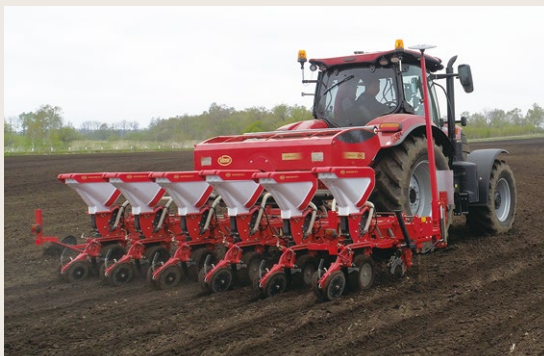
写真1. 真空播種機 MULTICORN DP II (株式会社ビコンジャパン)
