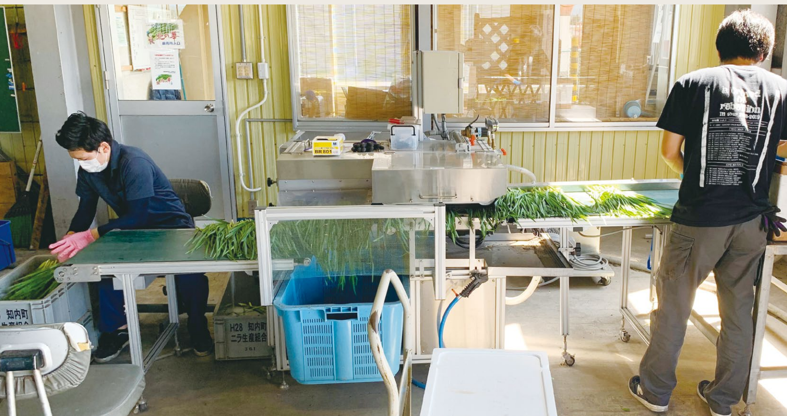
写真1. 試験導入した水圧式ニラそぐり機
