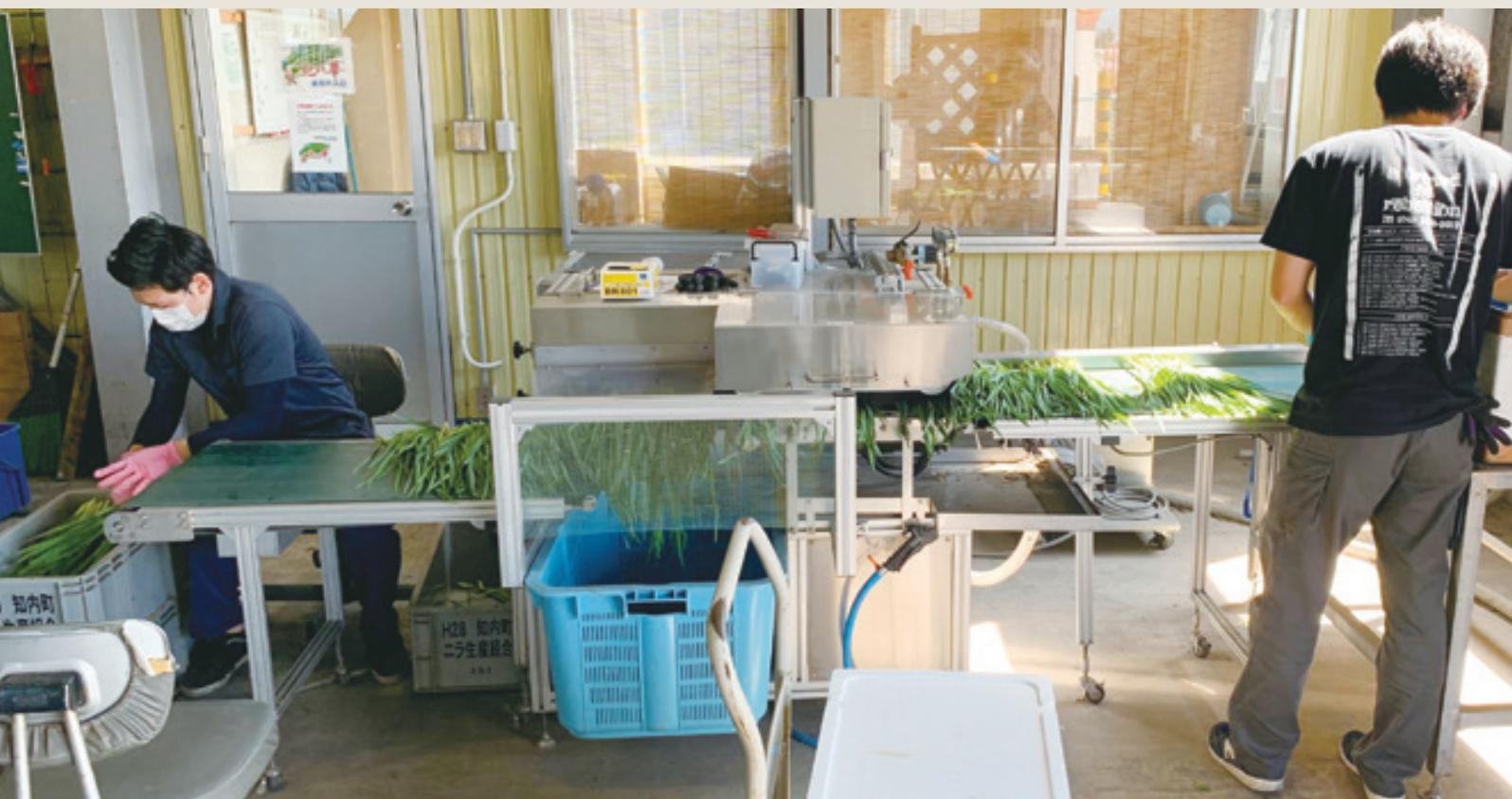
写真1. 試験導入した水圧式ニラそぐり機
