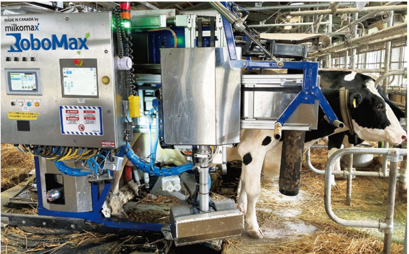
写真1. 搾乳ロボット全景
