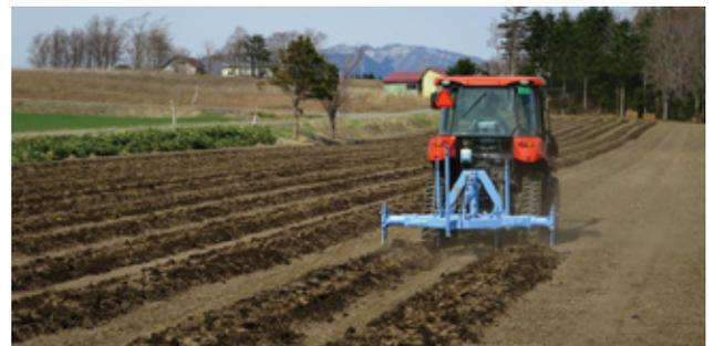
写真1. カットブレーカー施工の様子
