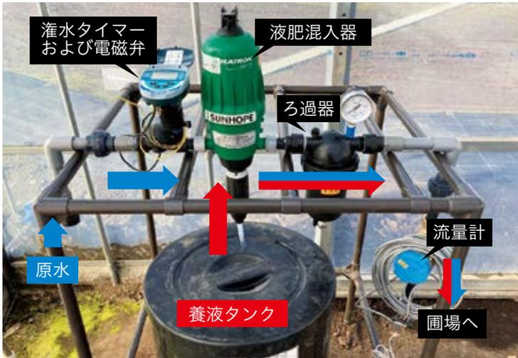
写真2. 本試験に用いた自動灌水システム
