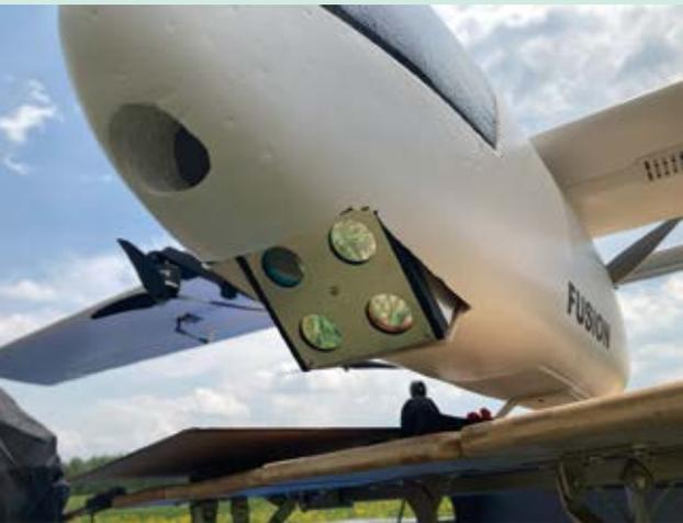
写真 1. リモートセンシング用 4 連カメラ
