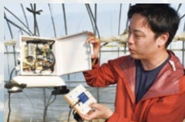
写真5. 飽差、土壌水分、日射量、CO 2 などがリアルタイムでチェックできます。「特に春先は何度もスマホで確認します」と水野さん。
