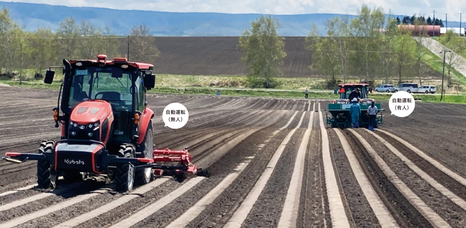
写真3. ロボットトラクタとの共同作業（左：ロボットトラクタによる培土、右：馬鈴しょの播種《植え付け》）
