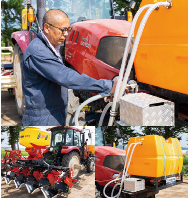
写真2. インファロー技術導入のため「アミーゴ」を装着したトラクター インファロー技術とは：カッティングプランターで植え付け時、植溝と寄せ土部分に薬剤を散布し、植え付けと同時に種芋周辺の土壌を防除できる技術。
