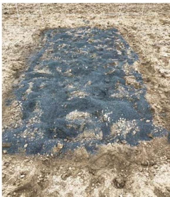
写真 4. 高機能バイオ炭を施用した圃場試験
