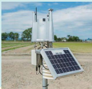
濱本さんの圃場に設置されているウエザーバケット。計測した数値が10分置きにサーバーに送られ、解析のためのデータとして蓄積されています。
