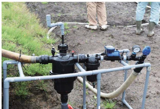
全農式点滴灌水器キットの灌水ヘッド部（フィルター、電磁弁、水圧計）
