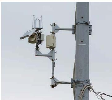
岩見沢市内13カ所に配置されている観測装置。気温、湿度、風向、風速、日射量などを10分ごとに計測して、データセンターに送ります。
