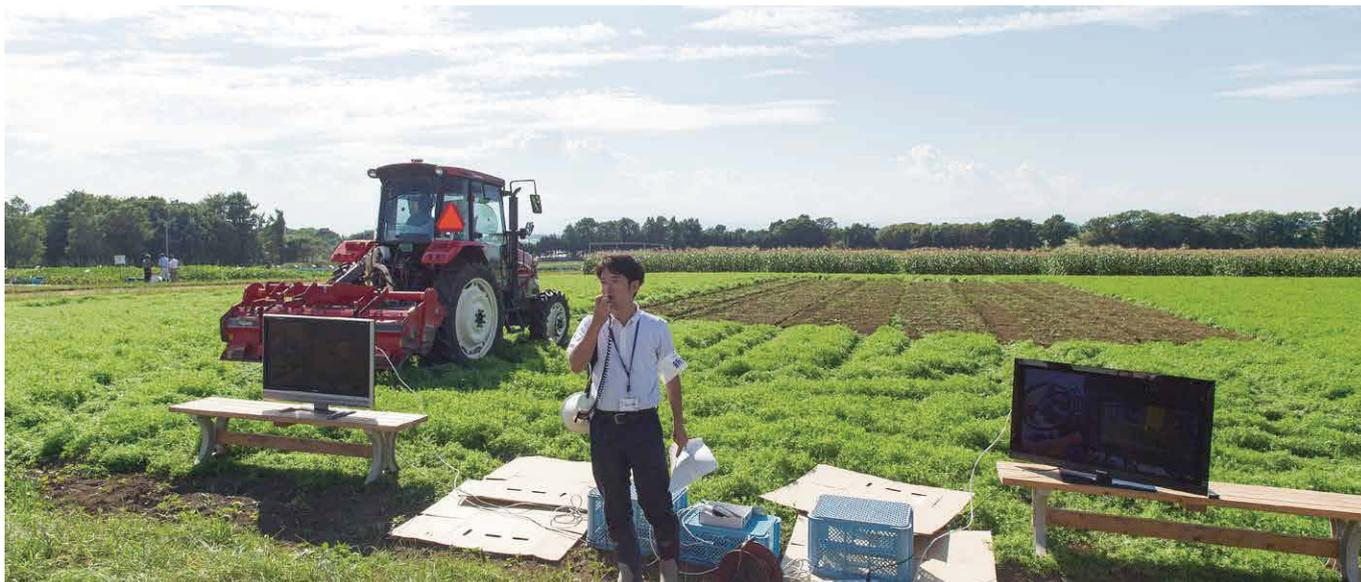
【トラクター】RTK 基地局からの補正信号により GNSS ガイダンスシステムの誤差は 2 ~ 3cm。定められた走行ルートをまっすぐ進む様子をご覧いただけました。
