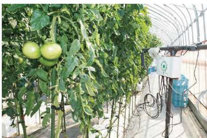
【みどりクラウド】ビニールハウス内に設置し、温湿度、地温、土壌水分、静止画などを遠隔地からスマートフォン等で確認できます。
